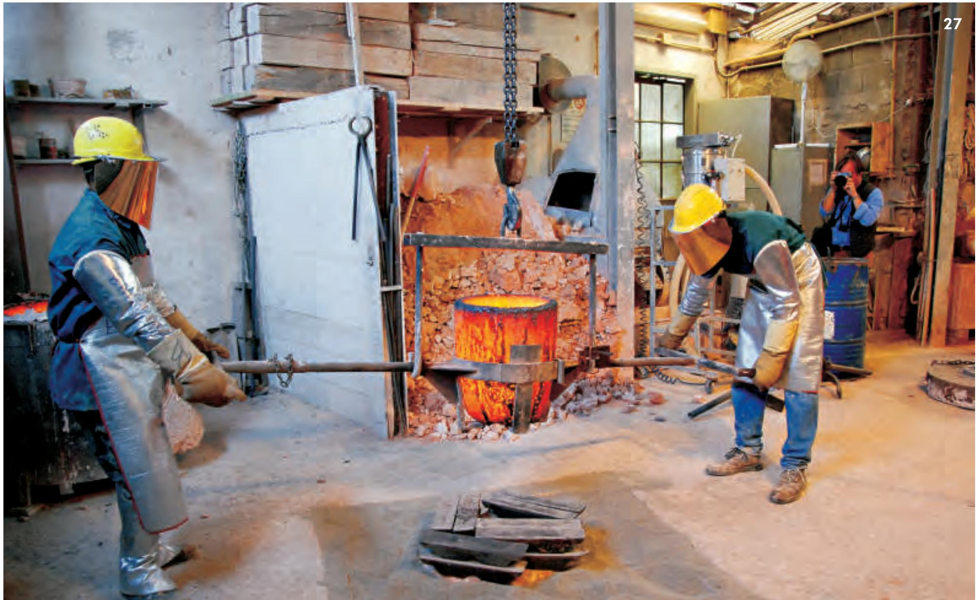
Die Metalle werden in einem Keramikiegel in einem Schmelzofen geschmolzen (**20+21**).
